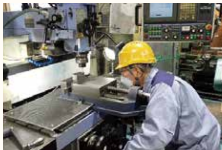
▲ 振動試験機の設計製作（フライス盤加工）
